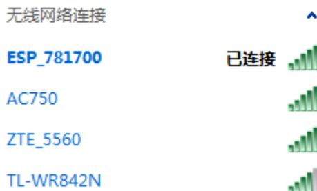
5. 在 PC 端使用网络调试工具，建立一个 TCP client，连接 ESP8266 的 TCP server。
